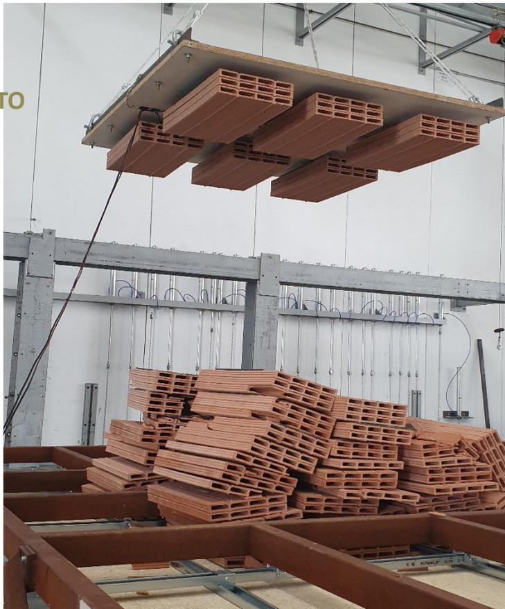
*Al carico statico finale di 528 kg sono stati sommati i 66 kg di carico dinamico per un carico complessivo di **540 kg/m<sup>2</sup>** senza arrivare al collasso del sistema.*
